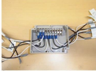
⑦ターミナルBOXにヒーター(2)とサーモスタット(2)を接続します。
