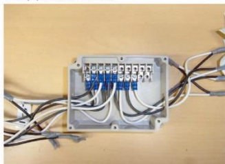
⑧ターミナルBOXにヒーター(4)とサーモスタット(4)を接続します。
