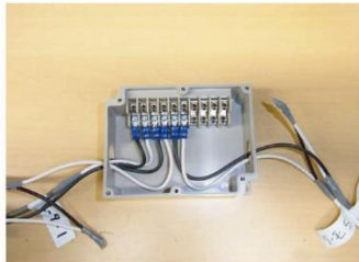
⑤ターミナルBOXにヒーター(5)とサーモスタット(5)を接続します。
