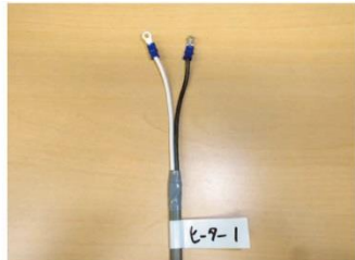
①ヒーター(1)終端に、丸端子および付帯処理を行います。
